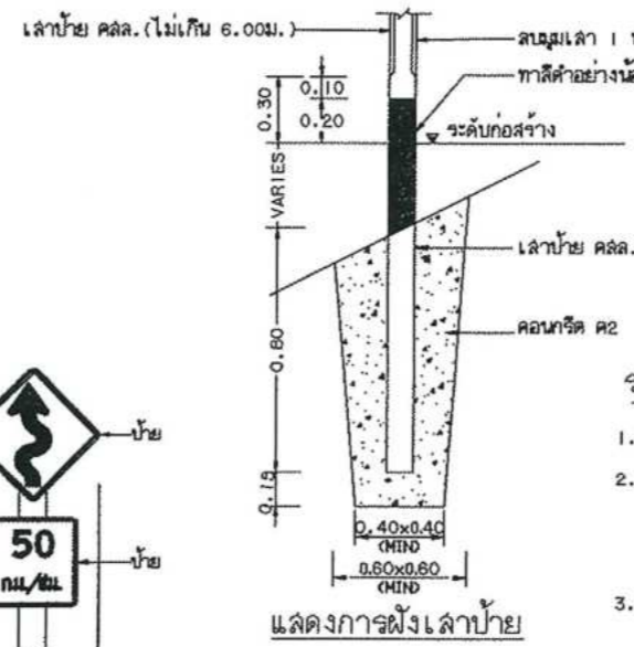
แปลนการปักเสาป้ายแนะนำ น-1 และ น-4
