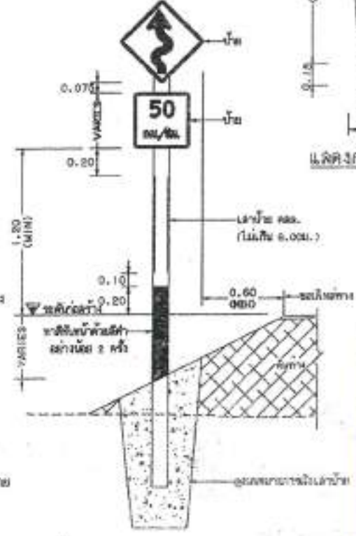
แสดงการปักเสาป้ายบังคับและป้ายเตือน
